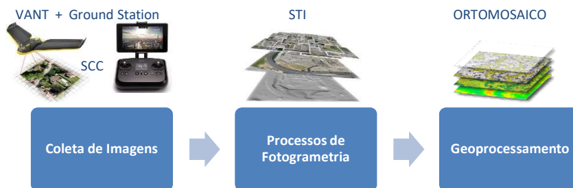
Figura 1: pipeline de geração de informação usando VANTs
